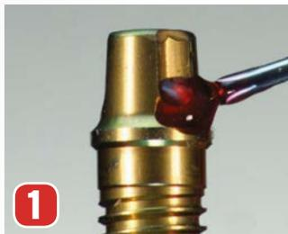
Zunächst werden mit primopattern LC Gel die einzelnen Kappchen der Implantat-
