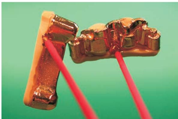
Abb. 21: Nach dem Galvanisiervorgang muß der Gips mit Gipslöser entfernt werden.
