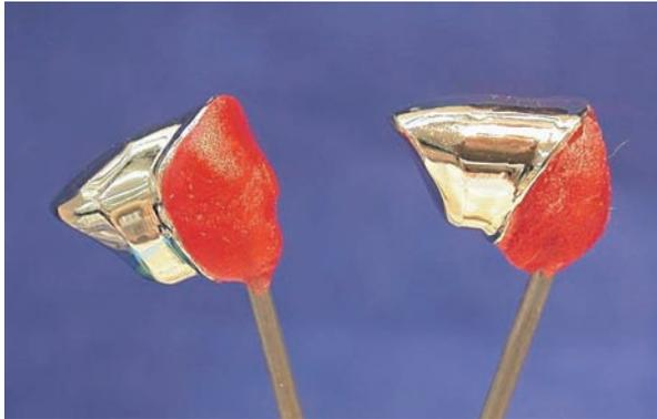
**Abb. 8:** Die Elektroden für die Galvanoabscheidung werden an die Primärteile
