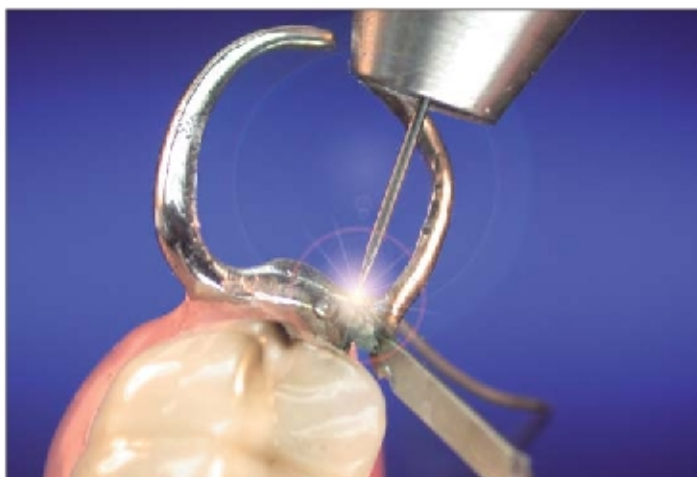
Abb. 8: Im Falle einer gebogenen Klammer sollte in dieser Phase der überstehende Teil des gebogenen Klammerarms abgetrennt werden.
