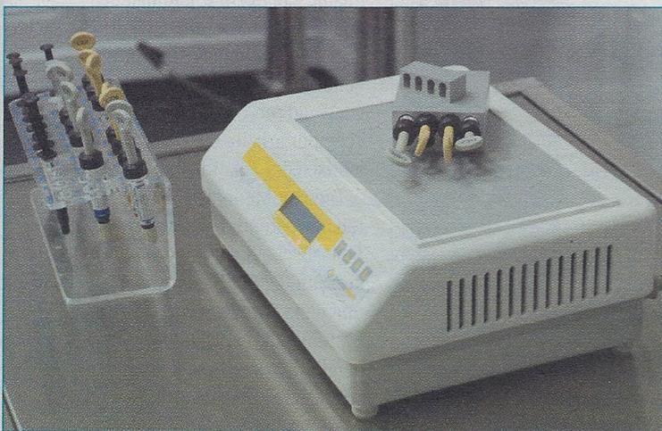
Abb. 1: Verschiedene Alublöcke zum Vorwärmen von Komposit-Spritzen ...
