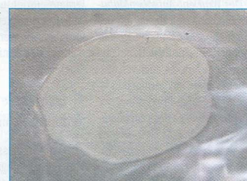
Abb. 4: Die Kugel wird mit Hilfe einer Glasplatte auf 1,5 Millimeter Schichtstärke gepresst.
