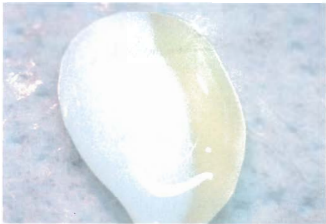
Abb. 50 Ein Kleber, der zur Zeit vom Autor getestet wird, zur Einklebung der Goldstrukturen in den Modellguss.
