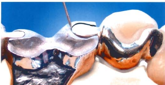
Abb. 36 Zu dem Zeitpunkt, wo die Plasmaelektrode sich vom Werkstück zurückzieht, setzt sich der Plasmastrahl über das Argon fort und führt zu einer punktuellen Verschweißung, ähnlich wie beim Laserschweißen.
