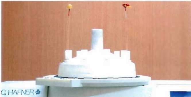
Abb. 25 Nach dem Bestücken des HELIOFORM Vario plus erfolgt die Abscheidung nach Herstellerangaben.
