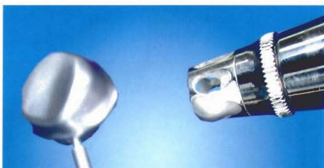
Abb. 22 Die Leitfähigmachung der Oberfläche wird mit der Airbrushpistole durchgeführt. Alle Bereiche, die keine Goldabscheidung erhalten sollen, werden mit einem Abdecklack zu den Abscheidungsbereichen begrenzt.
