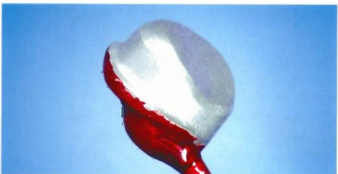
Abb. 23 Der gesprayte Silberleitlack ergibt eine optimale Oberfläche.
